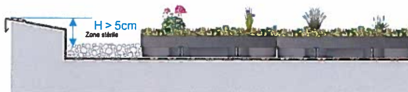
Figure 2a : Bacs précultivés ECOSEDUM PACK® en partie courante avec zone stérile en gravillons sur éléments porteurs en maçonnerie
