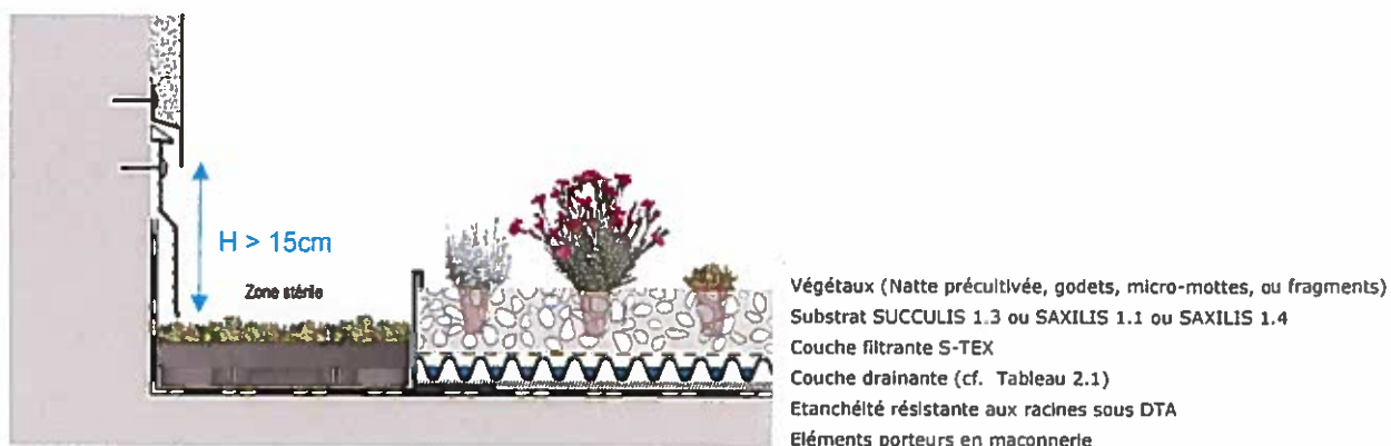
Figure 2b : Bacs précultivés ECOSEDUM PACK® (hors version BIODIVERSITE) en zone stérile lorsque la partie courante est en système multicouche
