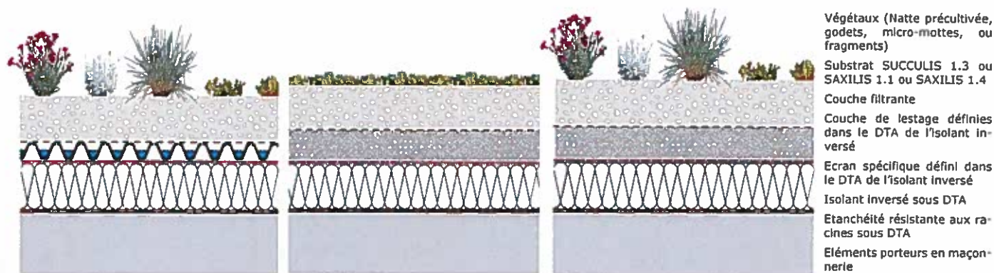
Figure 1 : Principe des systèmes de végétalisation ECOVEGETAL sur isolation inversée (Cf. paragraphe 4.7)
