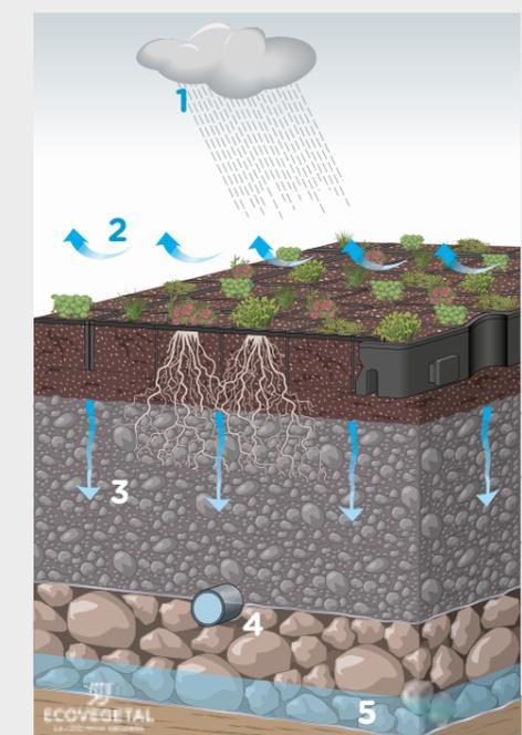
1. Phénomène pluvieux - 2. Evapotranspiration - 3. Infiltration - 4. Drain de sécurité - 5. Stockage temporaire
