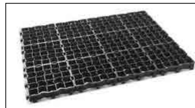
ECORASTER est un module alvéolaire fabriqué en polyéthylène basse densité (PEBD) issu du recyclage. Le système est certifié par le TÜV neutre pour l'environnement, résistant à la charge de 800 t/m<sup>2</sup> rempli, résistant aux UV et au gel.
