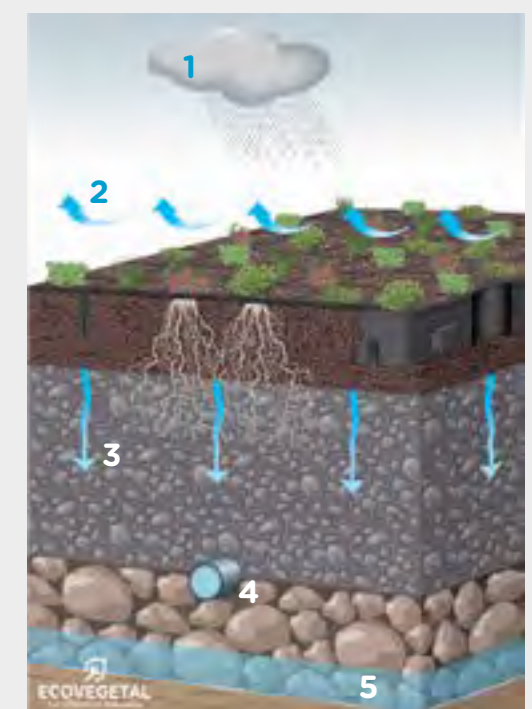
1. Phénomène pluvieux - 2. Evapotranspiration - 3. Infiltration - 4. Drain de sécurité (surverse) - 5. Stockage temporaire
