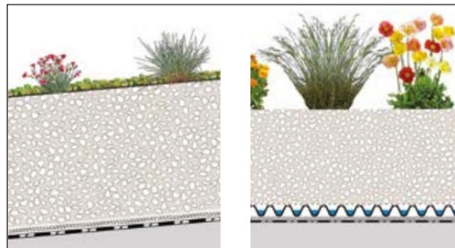
Le système de drainage est indispensable pour le stockage des eaux pluviales en toiture.
