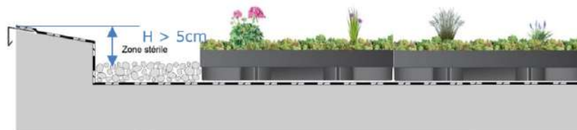
Figure 2a : Bacs précultivés de la gamme ECOSEDUM PACK® et ECOSEDUM PACK® EVO) en partie courante avec zone stérile en gravillons sur éléments porteurs en maçonnerie
