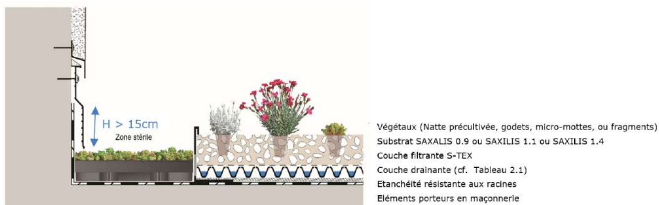
Figure 2b : Bacs précultivés de la gamme ECOSEDUM PACK® et ECOSEDUM PACK® EVO) (hors version BIODIVERSITE) en zone stérile lorsque la partie courante est en système multicouche
